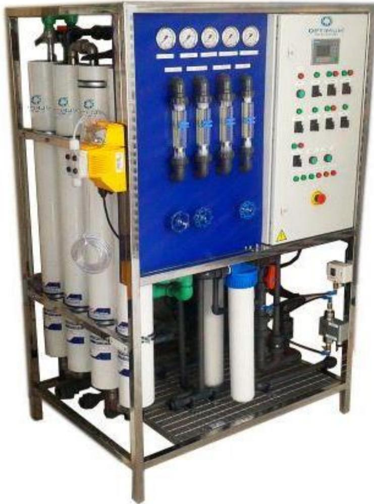
Unité de dessalement OWS OSMOTIC SOW, pour l'alimentation en eau déionisée pour l'irrigation et les industries, à travers une filtration sur sable et dessalement par membranes d'Osmose Inverse.
